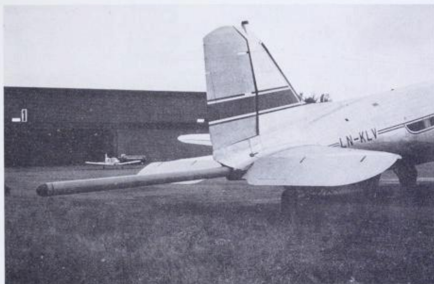
Fig. 24. Fly med halerør. Magnetometersensoren er plassert i enden av det ca. 5 m lange røret.
