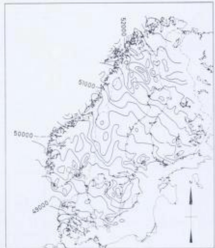
Fig. 15. Magnetisk totalfelt over Skandinavia med konturavstand 250 \gamma . Målingane er gjort i 3000 m flyhøgde og med 40 km profilavstand. (Dominion Observatory.)
