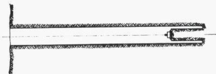
Fig. 16. Instrumenter for måling av spenninger i fjell. A) Flat-jekk. B) og C) Tøynings- eller deformasjonsmålere for henholdsvis periferien og bunnen av et bor hull.
