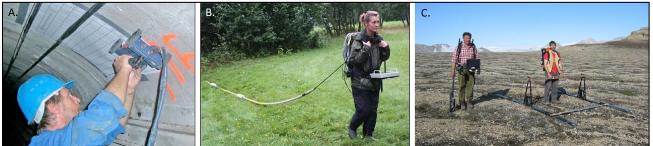
Figur 3.6: Eksempler på GPR-utstyr med forskjellig størrelse og funksjon. A) GSSI høyfrekvent radar for inspeksjon av armering i betong, B) Malå-radar med RTA-antennene ( Rough Terrain Antennas ) og C) S&S 25 MHz antenner i arbeid på Svalbard. (Foto fra GSSI, NGU og NGU).
