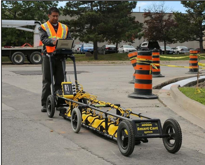
Figur 8.10: WARR-maskin her med 500 MHz senterfrekvens. Georadar med en sender og sju mottakere (bilde fra S&S).
