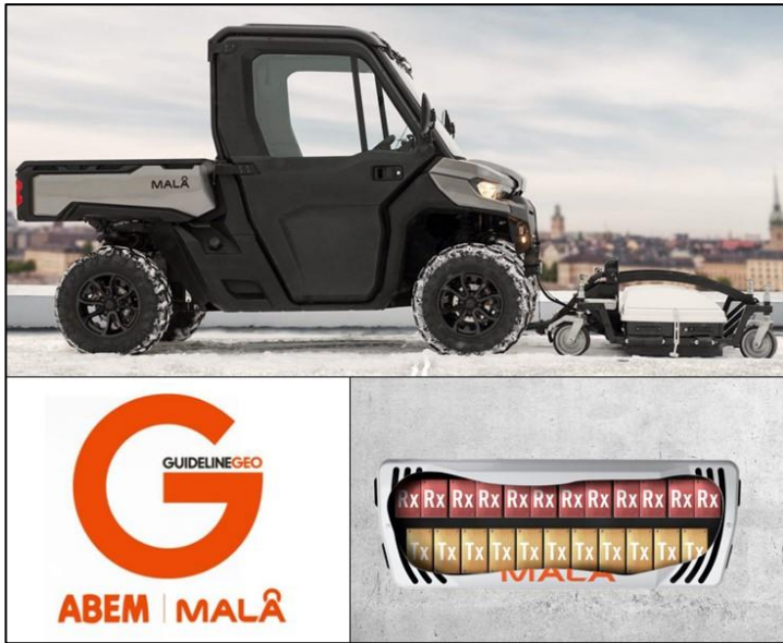
Figur 8.2: Presentasjon av Malå MIRA flerkanals 3D georadar (nedlastet fra https://www.guidelinegeo.com ).
