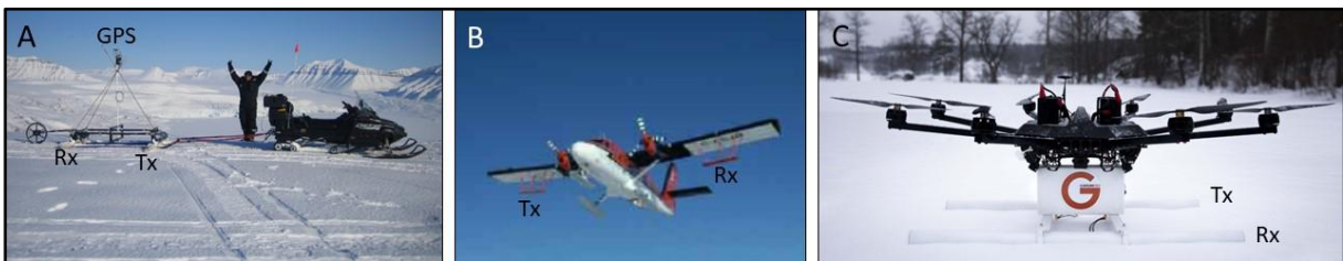
Figur 3.7: Eksempler på instrumentbærere, A) sleping med snøscooter, B) montering under vingene på et fly og C) transportert med Drone. (Foto fra NGU, Holt 2007, GuidelineGEO).
