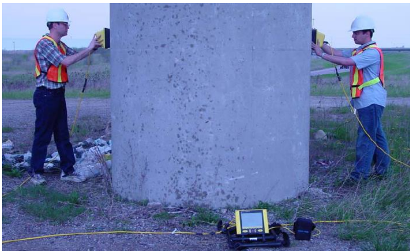
Figur 8.11: Eksempel på gjennomlysning med georadar, her en brupilar (Bilde fra S&S).
