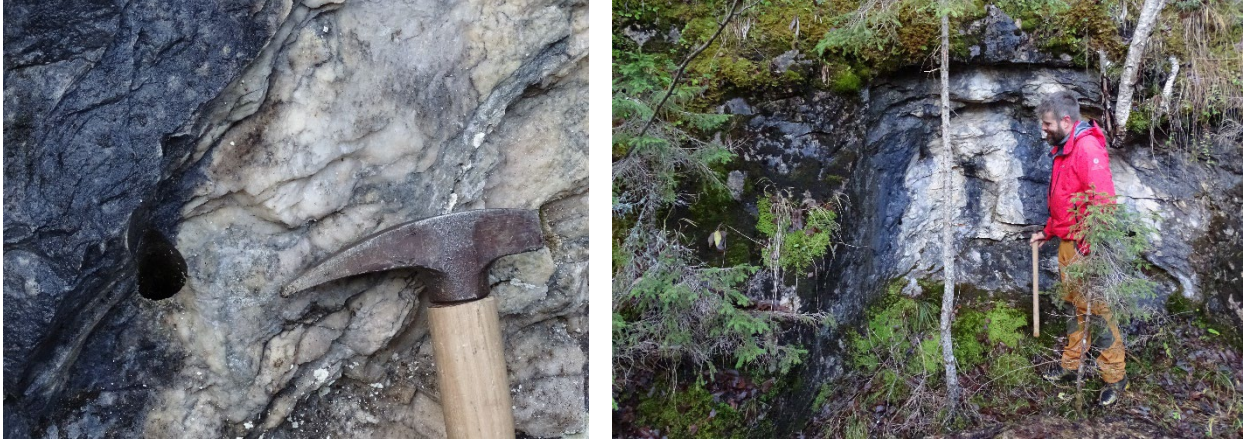
Figur 146 Hull etter en håndbormaskin i Dalsmark. Foto: A. Raaness
