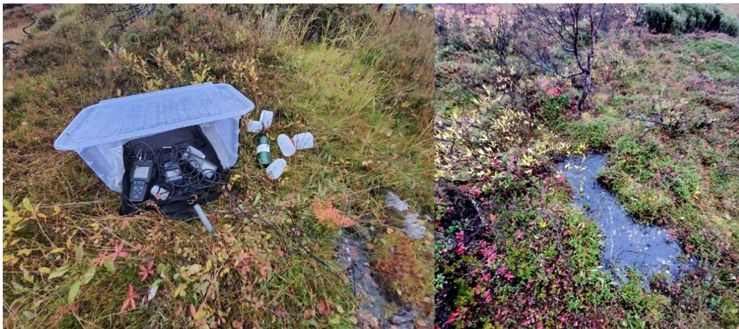
Figur 3.6.26b: Grunnvannslokaltet 26. Liten grunnvannskilde i grunn morene som trolig tilføres overflatevann i nedbørsperioder.
