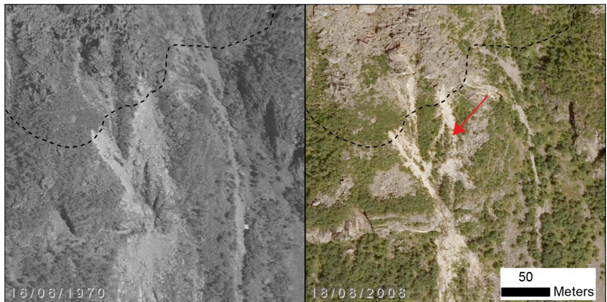
Figur 17: Skredaktivitet på nedre avgrensing av Tussafoten som var synlig i 1970 og som i 2008 er delvis dekt av vegetasjon i (Ortofoto: Kartverket)
