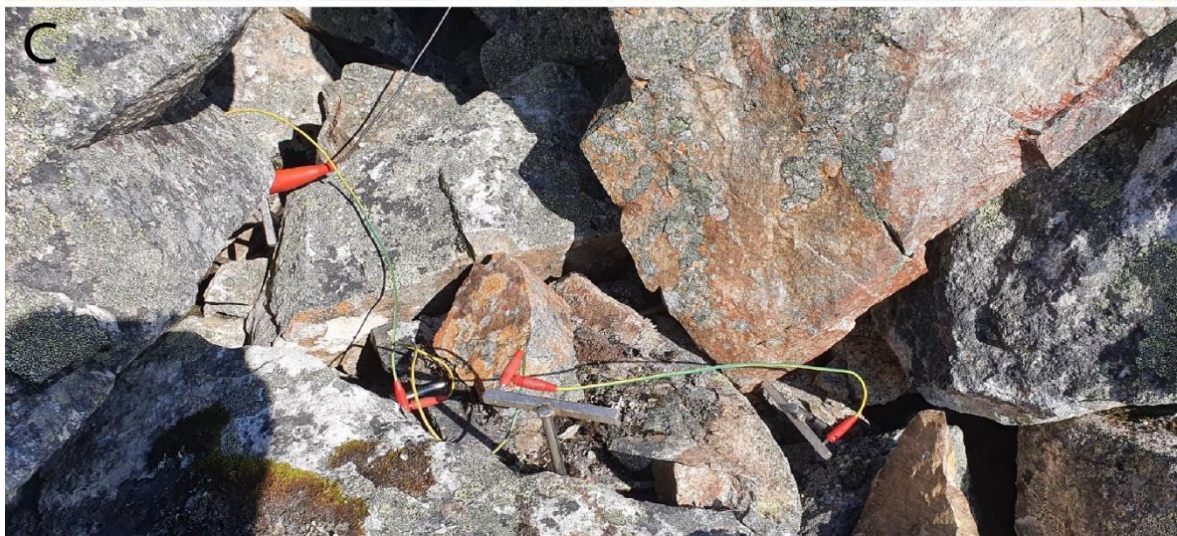
Figur 26: A: Utsikt mot NV fra midtpunkter til ERT Profil 1. B: Utsikt mot SØ fra midtpunkter til ERT Profil 1. C: Forholdene gjorde det nødvendig å bruke flere elektroder for å få god nok jording.
