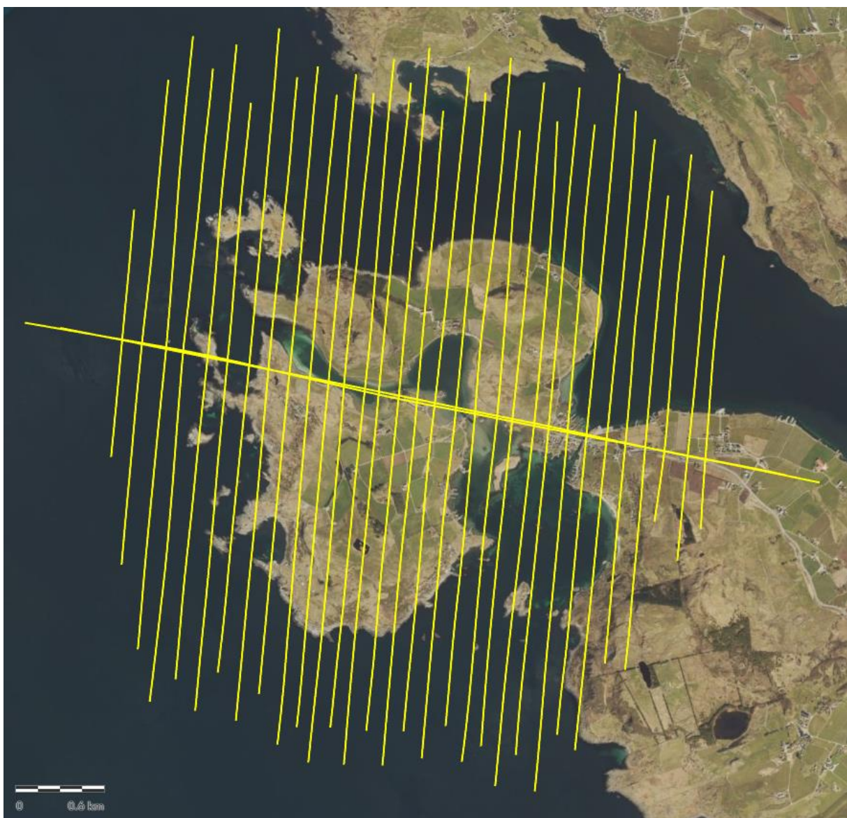
Figure 4.4. Flight lines from the Field LIDAR survey. Figure from høydedata.no (Kartverket, 2023).
