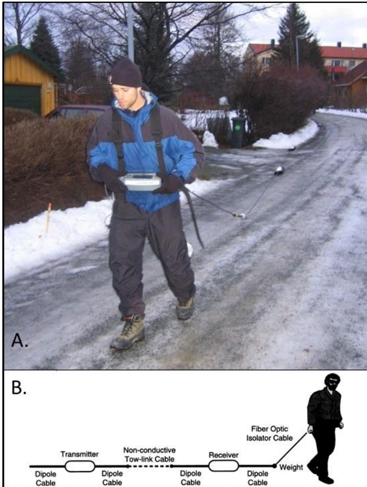
Figur 2.20: A) Målinger med kapasitive elektroder (instrumentet Geometrics OhmMapper®). B) Prinsippskisse av linjeelektroder ved dette systemet (Foto: NGU/JSR, Skisse fra Geometrics).
