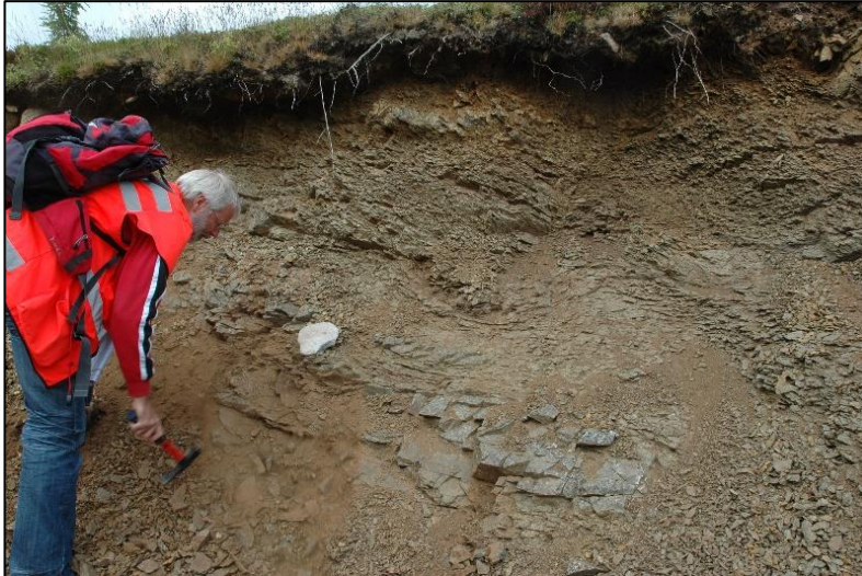
Figur 10.11: Eksempel på forvitret berg på Bjarkøya (Bilde fra SVV, Iversen 2012).
