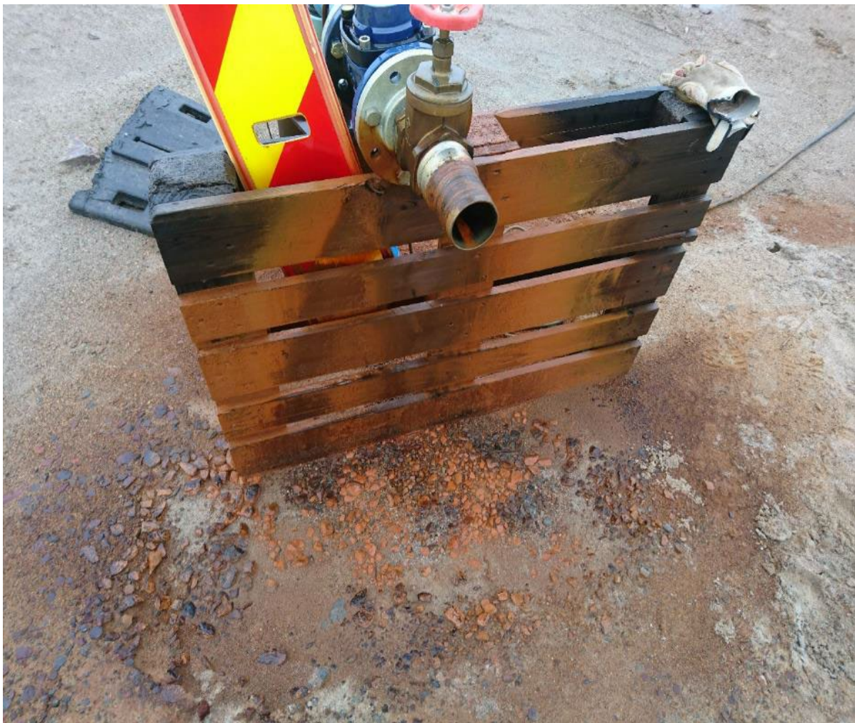
Figur 31. Jern og manganutfellinger fra grunnvannet i forbindelse med prøvepumping i Ydalir.
