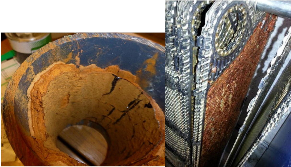
Figur 13. Jernutfelling i rør og varmeveksles fra Melhus. Foto: Randi K. Ramstad.
